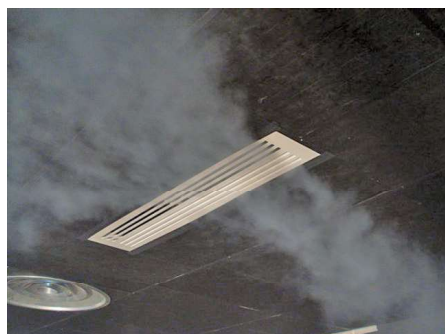
Visualisation du jet d'air en soufflage / reprise.
