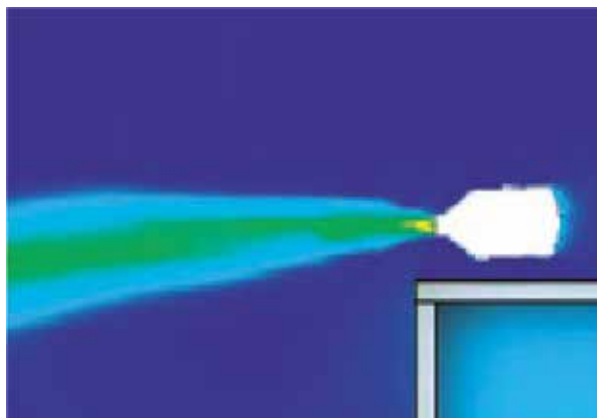
Représentation par simulation numérique du jet d'air d'un Harmony Vertical (vue de dessus).
