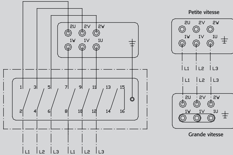
• 2 vitesses Bobinage - Indépendant 400 V
